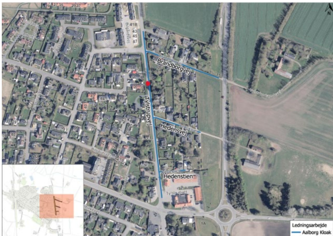
Figur 1: viser den analysefritagede strækning markeret med blå. Den røde prik angiver en boring, hvor der er påvist forurenede jord med kulbrinter og PAH'er. Denne boring og vejstrækningen 5 meter på hver side af boringen er derfor ikke omfattet af analysefritagelsen.
