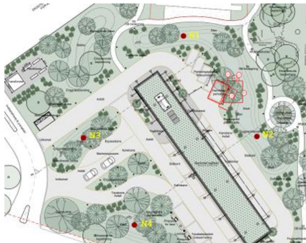
Figur 6: Angivelse af placering for borer ved nedsivningsundersøgelse på Ny Lufthavnsvej.
