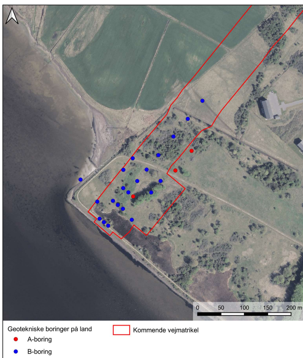
Figur 1-1: Oversigtskort over boringernes placering ved Verdens Ende. Alle A-boringer er pejleboringer og borer, hvor der kan udtages vandprøver. Målestok: 1:5.000.
