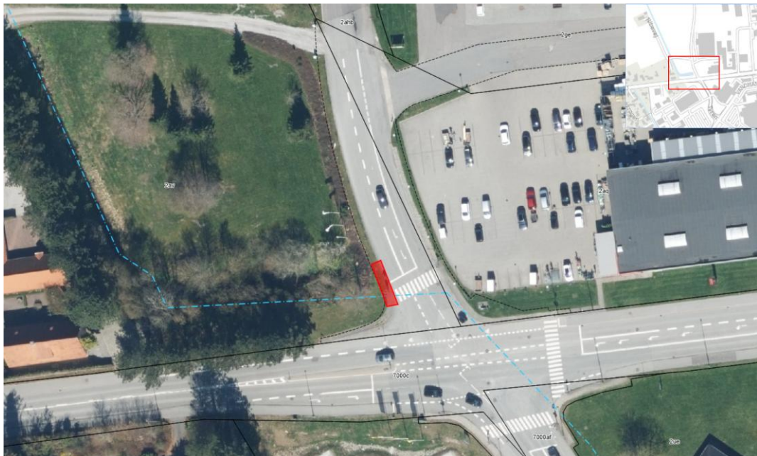
Figur 1 - Oversigtskort over projektområdet. Den røde markering indikerer, hvor etableringen af nye elkabler, ved styret underboring, krydser det rørlagte vandløb. Krydsningen sker omkring koordinaterne 6318385,552825 UTM Zone 32N
