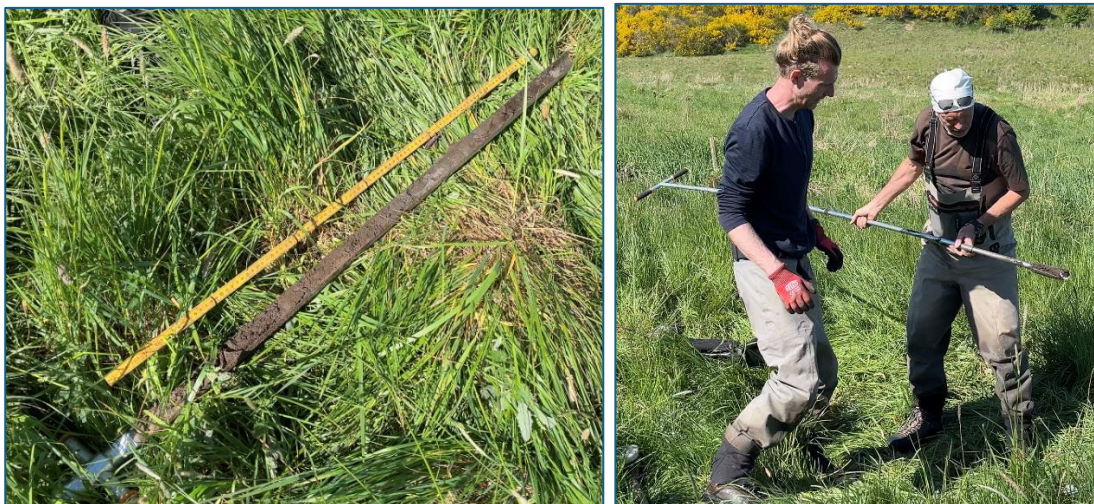
Tørvejord i den øverste meter på Binderup Engen, samt undersøgelse af stikprøve af jordtype i 2 meters dybde.
