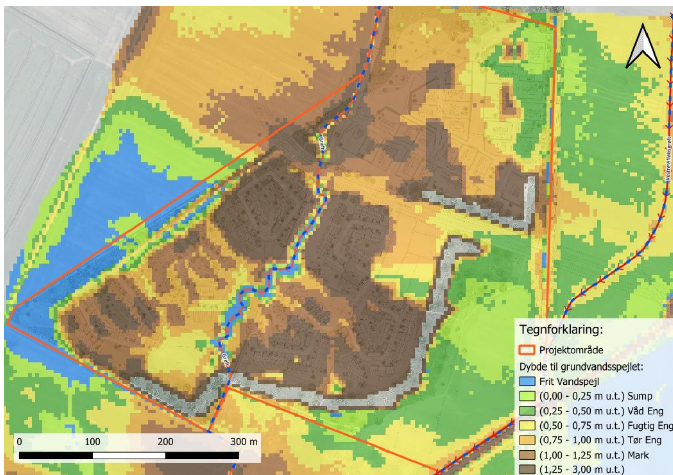
Figur 4.5: Afvandingspotentiale ved en vintermedianmaksimal afstrømning med opstuvning til overløbskant svarende til kote +3,2 mDVR90 i "ådal" og fremtidig terrænreguleret terræn.
