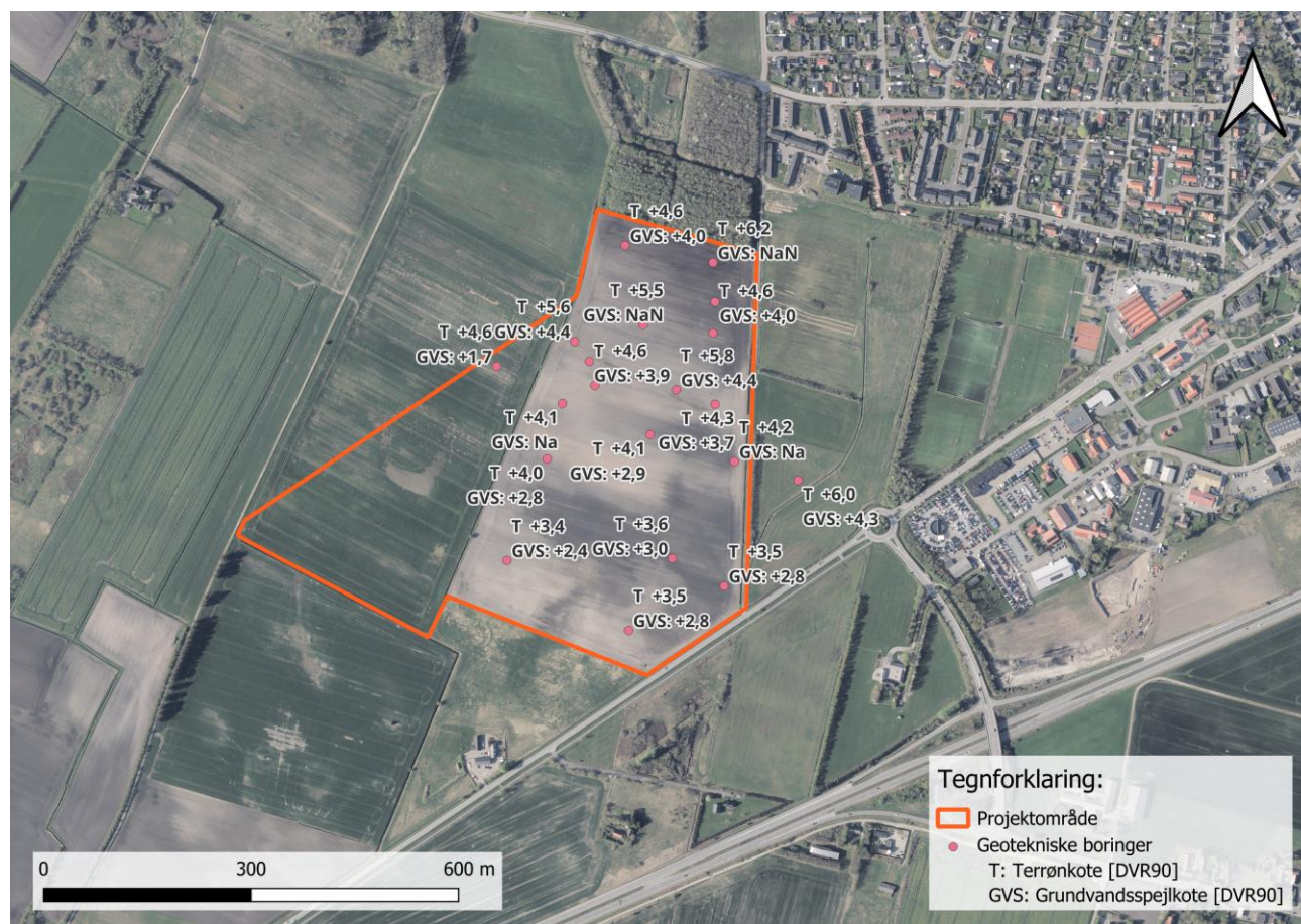
Figur 3.2: Oversigt over geotekniske borer.
