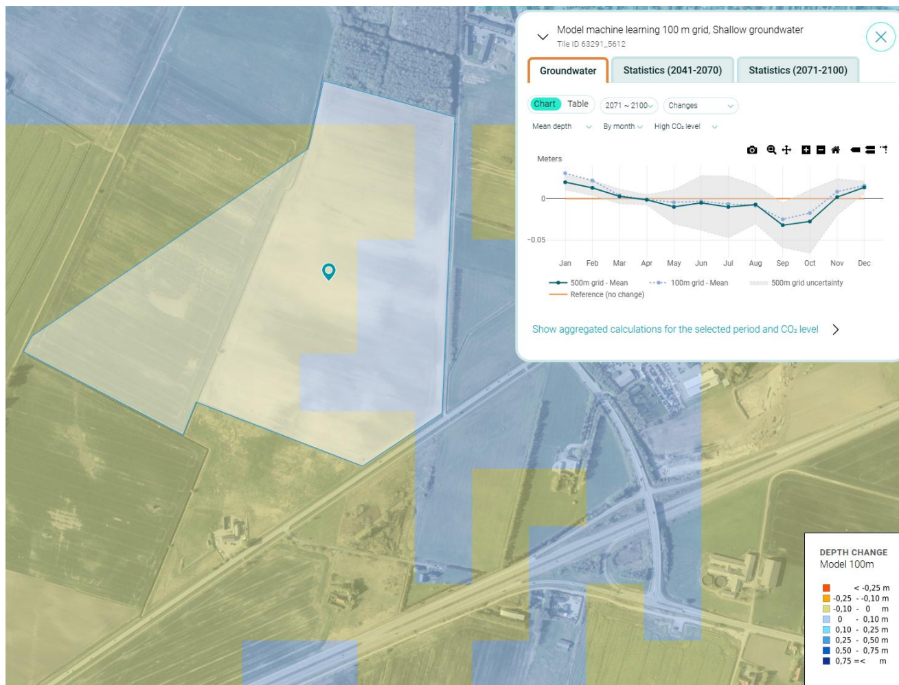
Figur 5.3: Modelberegnete, med maskinlæring for 100 m grid, ændringer i det terrænnære grundvandsspejl for middel dybde i fjern fremtid (2071-2100), ved anvendelse af klimascenariet RCP8.5
