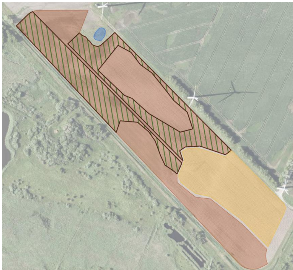
Figur 2-2 Reopløjning i 70 cm dybde på grønt skraverede områder.
