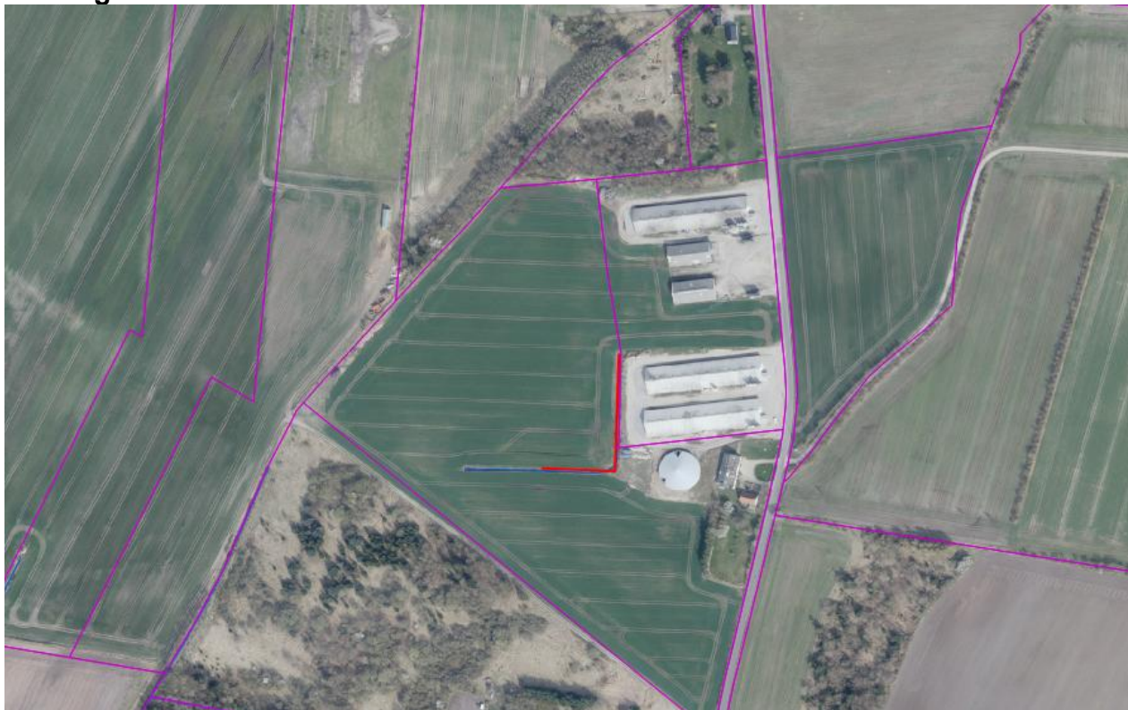
Figur 1 Oversigtskort over projektområde. Den blå linje indikerer det private vandløb. Den røde linje indikerer den vandløbsstrækning der rørlægges.
