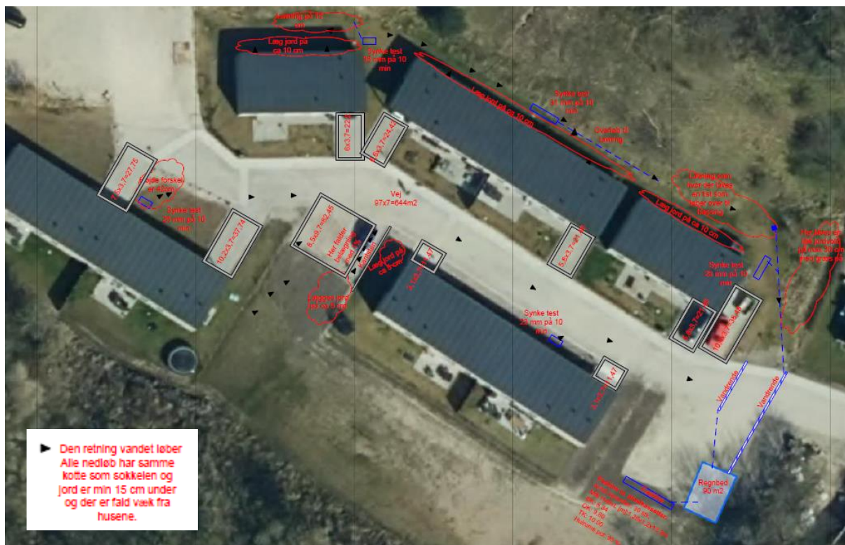
Figur 3: Placering for regnbed og faskiner for parcelhusområde på Skovskrænten, 9260 Gistrup. Billedet angiver desuden vandets strømningsretning ved angivelse af pile. De hvide firkanter er arealoppgørelse for parkering og indkørsler. De blå firkanter er faskiner. Regnbed er angivet med blå kant og udfyldt med lys skravering. Røde markeringer er angivelse af placering for nedslivningstest samt beskrivelser i forhold til fokusområder, der håndteres i forbindelse med etableringen.
