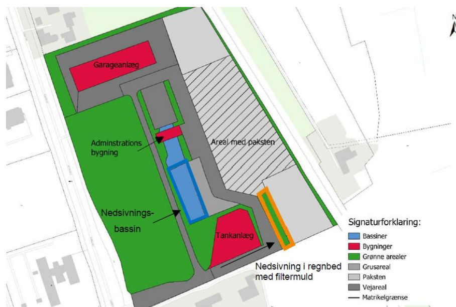
Figur 1: Arealopgørelse over projektområdet for LAR-system på Brøndborens Alle, Svenstrup. Søen og nedsivningsbassin er markeret med blå (nedsivningsbassin er derudover markeret med blå firkant). Regnbed er markeret med orange firkant. Område med diffus nedsivning er det skraverede område af pakstensområdet. Garageanlæg og tankanlæg (arealerne markeret med rød er ikke del af LAR-systemet).
