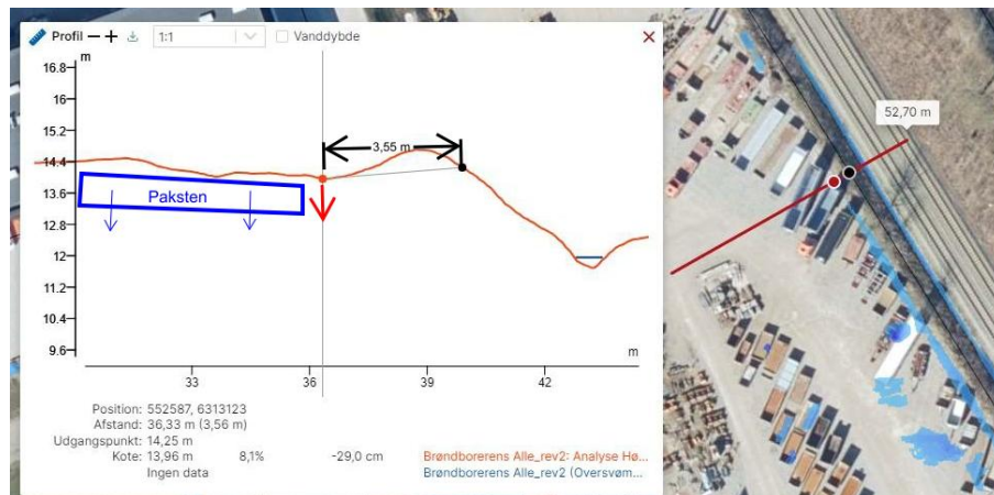
Figur 12: Udsnit, der angiver laveste punkt på tværsnit af areal mod banen for Brøndborens Alle, Svenstrup.
