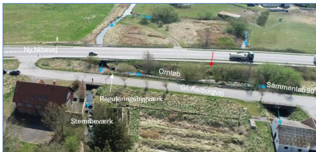
Fig 15. Overblik over vandstrømmene (blå pile) og reguleringsbygværket ved Binderup Mølle. Det 60 m lange omløb ved Ny Nibevej løber sammen med Gl. Aalborgvej. Rød pil viser tydelig erosion, men erosionsrisiko begrænses ikke kun til det ene sted.
