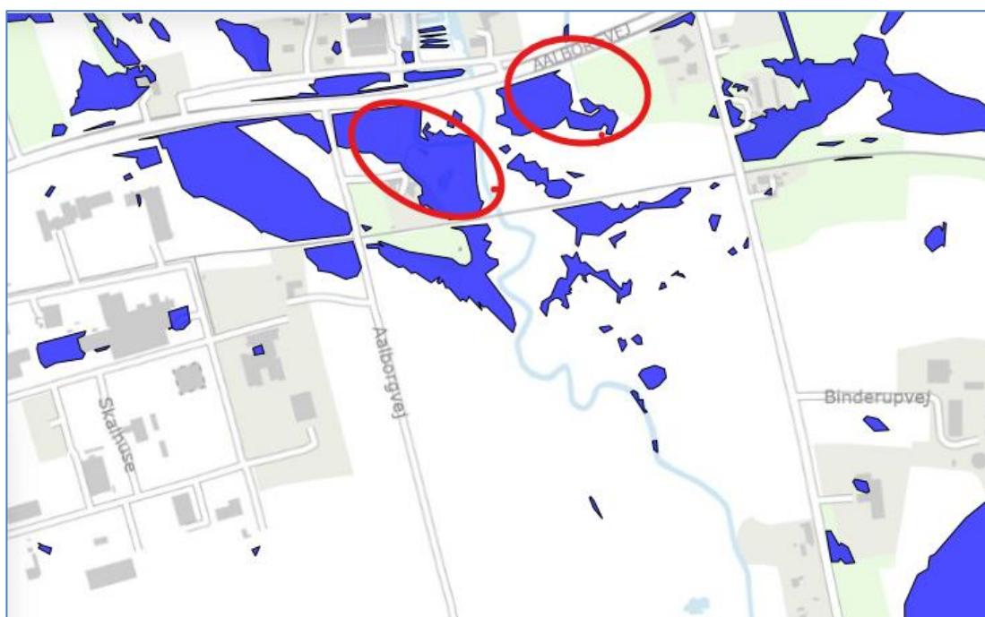
Fig 14. Kommuneplan, risiko for oversvømmelse og erosion. Det ses at der er risiko for oversvømmelse op mod vejanlæg og på privat ejendom i de rødmarkerede områder.
