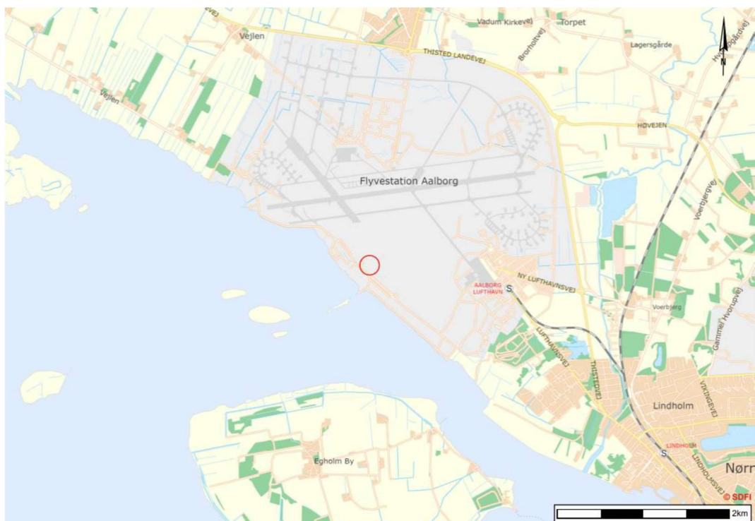
Figur 1: Oversigtskort. Den røde cirkel markerer placeringen af projektområdet på matrikel 1dt Rødslet Hgd., Vadum, hvor der ønskes etableret nye drænstrenge, pumpe og pumpeledning m.m. Målestok er angivet i nederste højre hjørne. Baggrundskort © SDFI, 13.09.2024/WMS-tjeneste, skærmkort.
