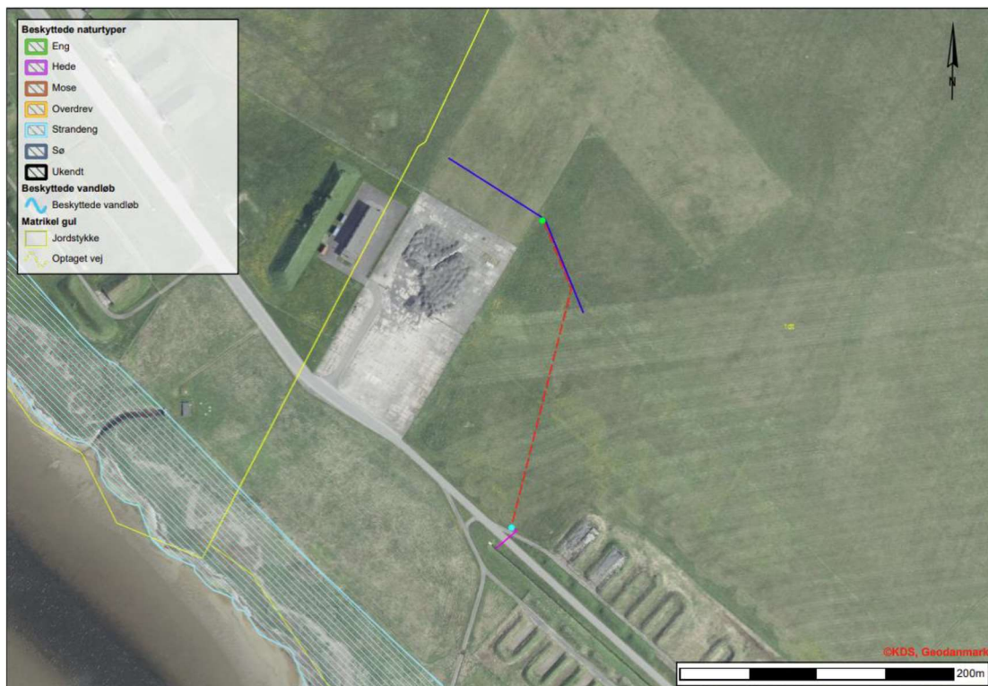
Figur 2: 2024-luftfoto. Figuren viser området på matrikel 1dt Rødslet Hgd., Vadum, hvor der ønskes etableret nye drænstrengte, pumpe og pumpeledning m.m. De blå linjer markerer nye Ø126 drænstrengte. Det grønne punkt markerer pumpebrønd. Den stiplede røde linje markerer Ø63 pumpeledning. Det turkise punkt markerer Ø315 plastbrønd. Den lilla linje markerer 18 meter afløbsledning fra brønd til udløb i privat åbent vandløb. Beskyttede naturtyper er vist med signaturforklaring i øverste venstre hjørne. De gule streger angiver matrikelskel. Målestok er angivet i nederste højre hjørne. Baggrundskort © SDFI, 13.06.2025/WMS-tjeneste, Ortofoto forår 2024, matrikeldata og beskyttet natur. Indeholder data, som benyttes i henhold til vilkår for brug af danske offentlige data.
