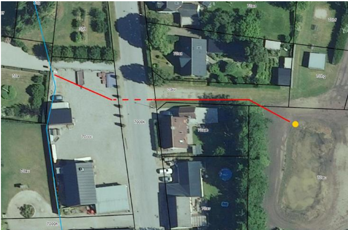
Figur 1: Placeringen af det nye rørlagte vandløb fra sandfangsbrønd (gul prik) til udløb i Øster Hassing Hede­bæk (blå linje) er markeret med en rød linje på oversigtskort med matrikelskel.
