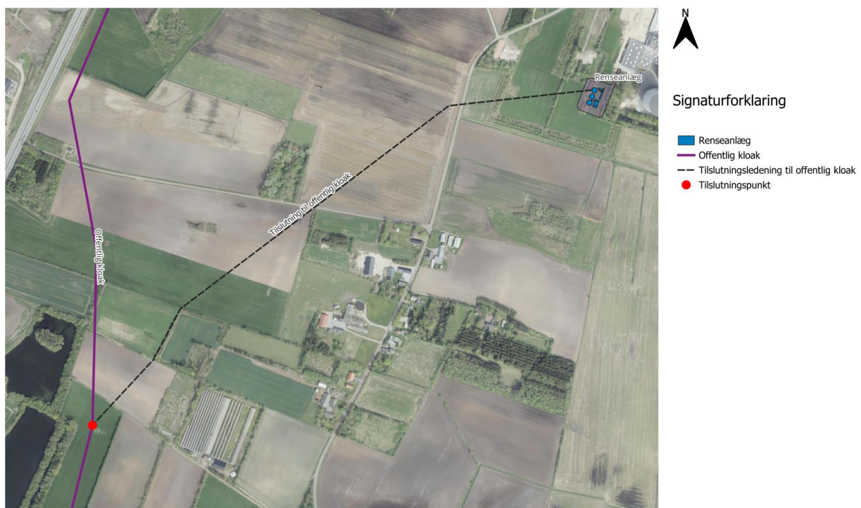
Figur 1: Spildevandsledningens forløb fra AKV AmbA til tilslutningspunkt til Aalborg Forsyning A/S' spildevandsledning
